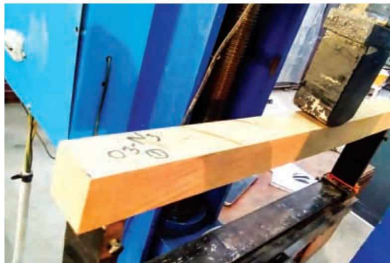
टी. अनडुलाटा काष्ठ के यांत्रिक गुणधर्मों का परीक्षण
