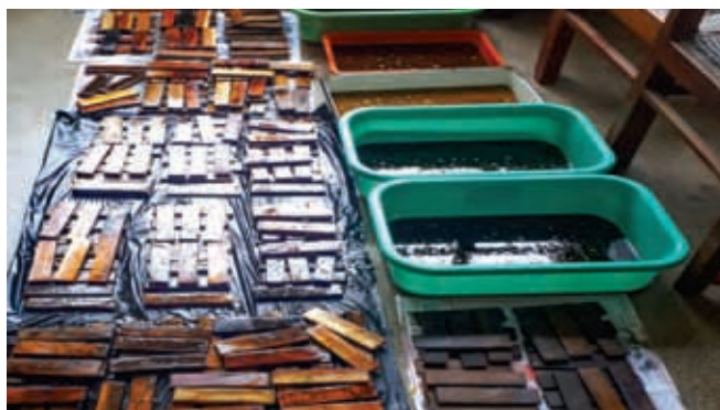
कर्नाटक के नल्लल में क्षेत्र प्रयोग में स्थापित कंट्रोल, सीसीबी और छह नीम नुस्खे उपचारित नमूने
