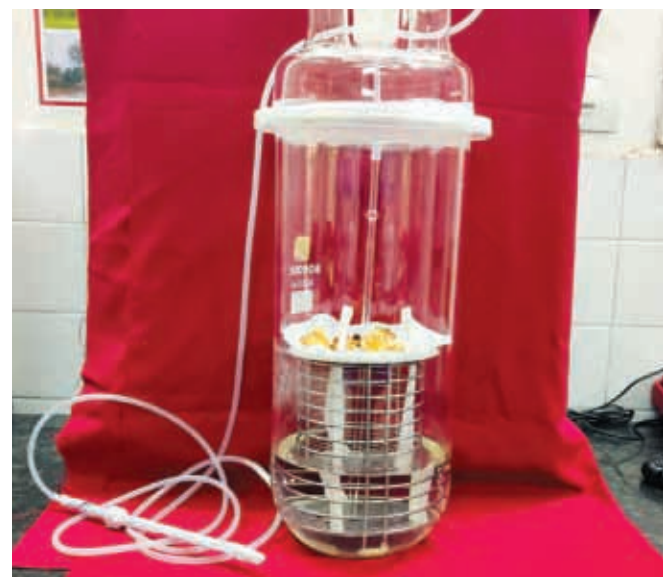
माध्यम एवं कैलस संवर्धन युक्त बायोरिएक्टर का आदिप्ररूप विकसित करने हेतु संवर्धन पात्र
