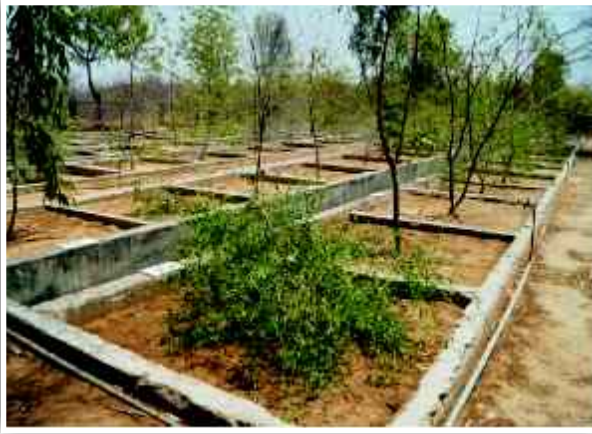
पादप उपचार के लिए लाइसीमीटर परीक्षण
